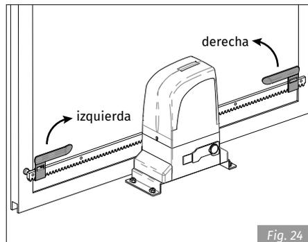
1 • Después de instalada la cremallera, llevar de nuevo el portón a la posición de cerrado y posicionar la chapa/placa de fin de carrera en la cremallera. En esta posición de cerrado, la chapa/placa debe accionar el fin de carrera del motor.
