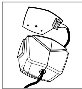
2 • Haga las conexiones en el PCB.
