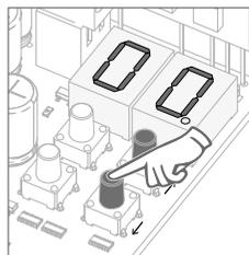
08 • Aparece la función definida de fábrica. Si desea, cambie la función de 00 o 01 utilizando ↑ ↓.
