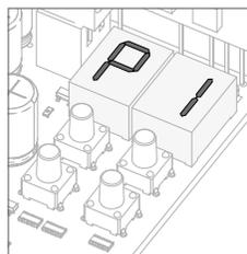
04 • Cuando surge P1, la programación automática terminó. Si desea programar P1 continúe con el paso 03 de menú P1. Para salir de la programación presione ↑ ↓ simultáneamente.
