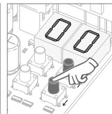
04 • Aparece la función definida de fábrica. Si desea, cambie la función de 00 o 01 utilizando ↑ ↓.
