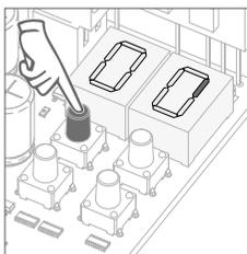
03 • Aparece un movimiento circular en la pantalla indicando que el ajuste automático está en marcha.
